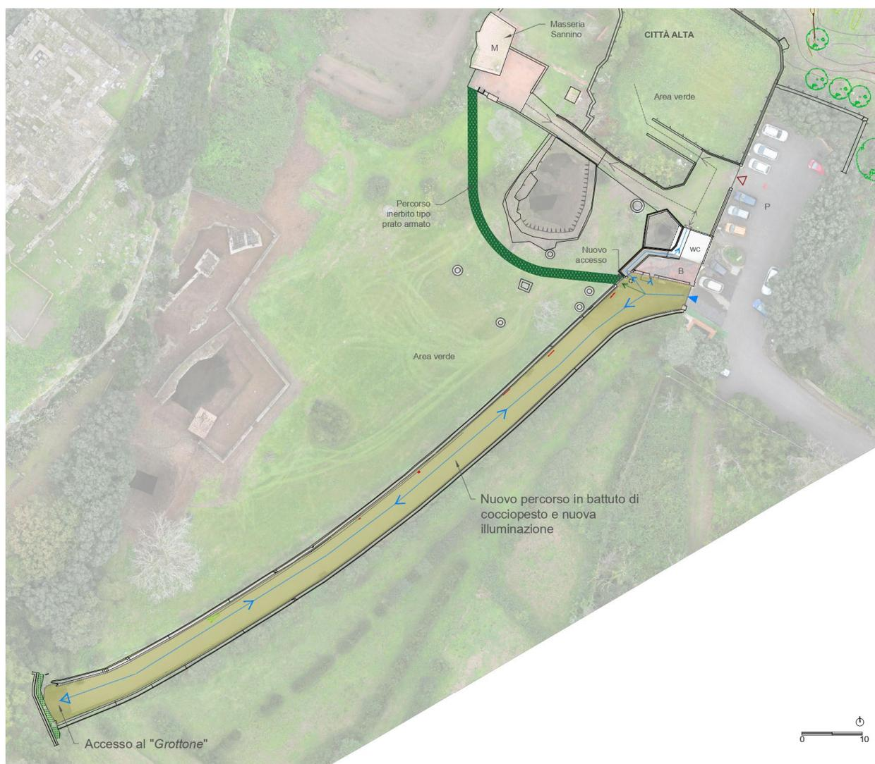
Figura 20 – Schema di progetto per l'intervento di rifacimento del battuto del viale d'accesso al Grottone
