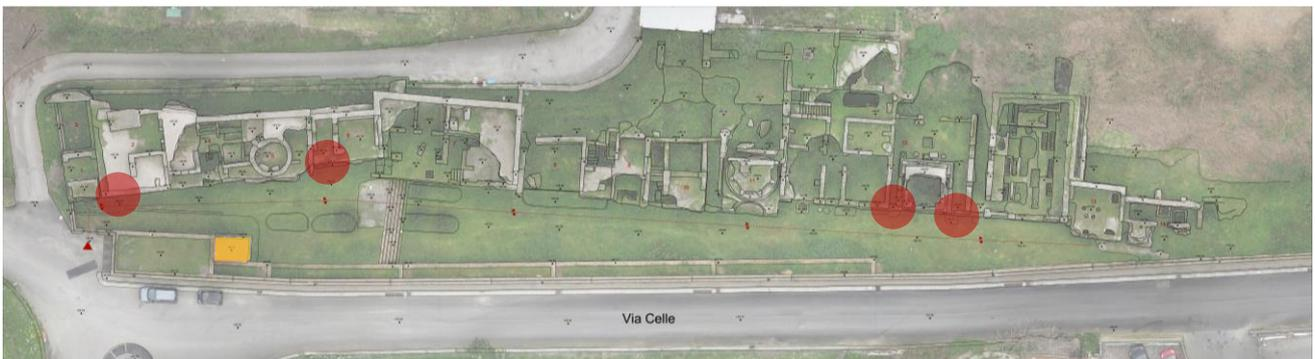
Figura 8 – Planimetria del complesso con indicazione delle zone di installazione delle scale metalliche - in rosso - e demolizione del volume moderno incongruo – in giallo - (progetto FSC)
